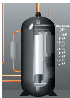
Компрессор с инверторным управлением. Мощность изменяется плавно
