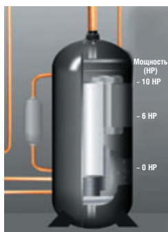
Компрессор переменной производительности. Мощность изменяется ступенчато
