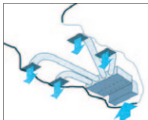
Установка в запотолочном пространстве
