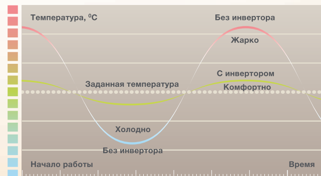
Схема работы DC инвертора
