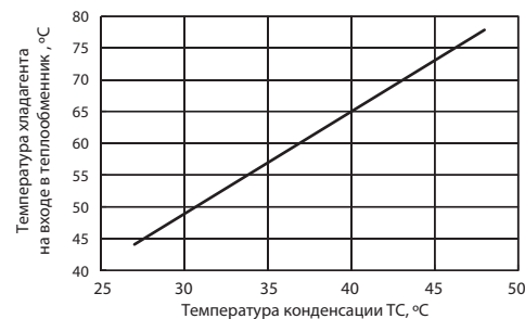
Рис. 2. Температура хладагента на входе в теплообменник
